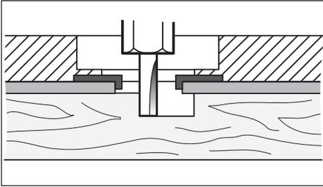
Pulse la palanca de sujeción (8) y coloque la máquina lentamente en la pieza hasta la profundidad de fresado configurada.
