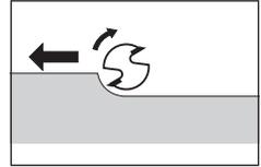
Si se realiza el fresado en el sentido de giro de la fresa (funcionamiento concordante), puede escaparse la máquina de las manos.
