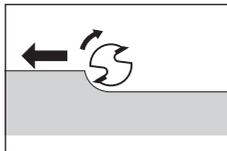
При фрезеровании в направлении вращения фрезы (последовательный ход) машина может вырваться из рук обслуживающего персонала.
