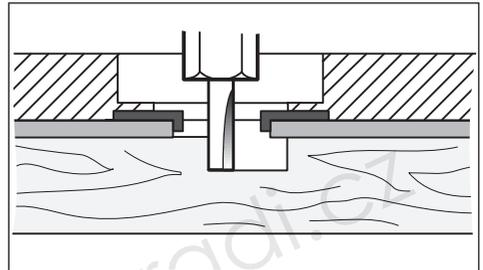
Nyomja meg a rögzítő kart (8) és a gépet lassan engedje le a munkadarabhoz, amíg el nem éri a beállított marásmélységet.
