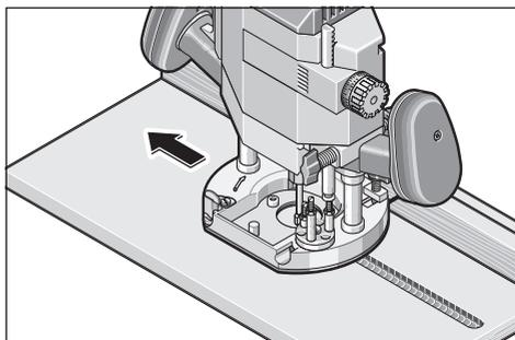
Zadní rovnou ploskou stranu kluzné desky (15) vedte podél vodící lišty. **Dbejte směru posuvu: Aby se zabránilo „utíkání“ stroje od dorazové lišty, je důležité, aby byl stroj veden tak, jak je ukázáno.**
