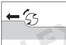
Při frézování ve směru otáčení frézy (sousedný běh) může být stroj vytržen obsluze z ryku.
