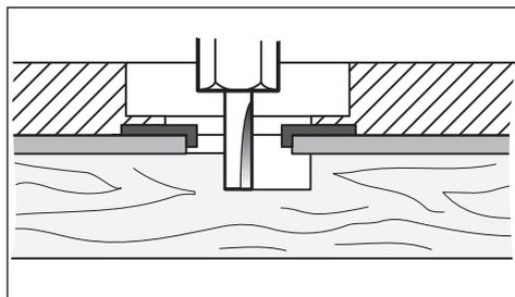
Przycisnąć dzwignię zaciskową (8) i powoli opuszczać maszynę w kierunku obrabianego przedmiotu, aż do momentu osiągnięcia ustawionej głębokości frezowania.
