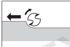
A marószerszám forgási irányában végzett marás esetében (azonos irányú mozgás) a gép kifordulhat a felhasználó kezéből.
