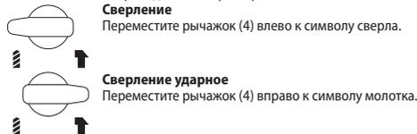
Сверление ударом рекомендуется использовать для бетона, стали и керамики. Рычажок переключателя (9) должен быть всегда установлен на правый ход.
