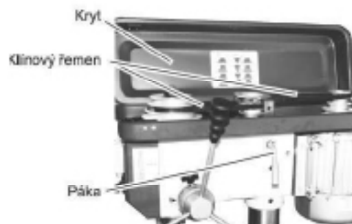
Obr. 4-5: Napnutí klínového řemene
